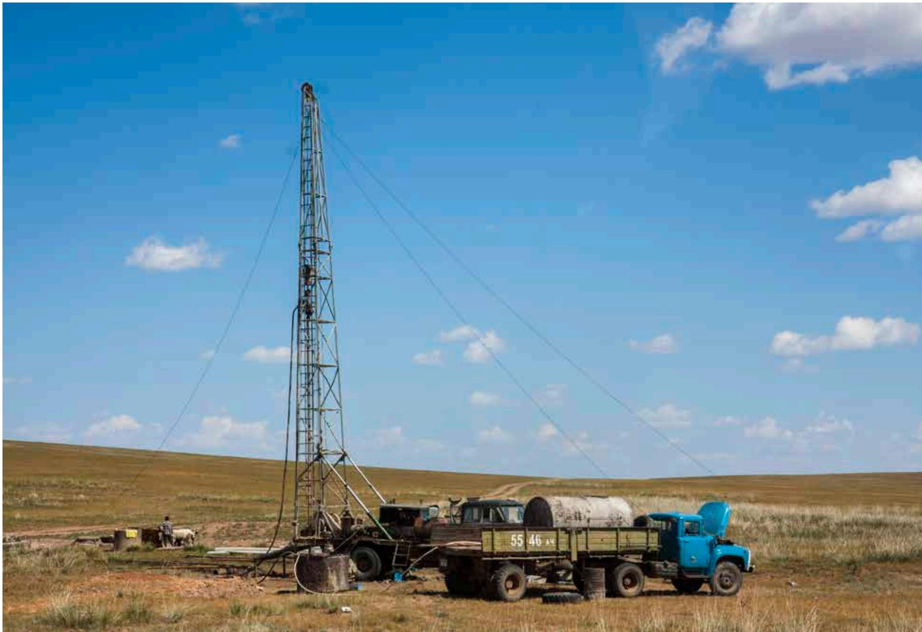
**Neue Wasserbohrung in der Gobi – bis zu 80 Meter tief**
